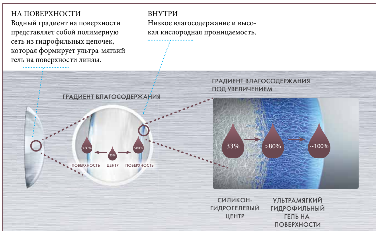
Рисунок 1. Структура материала водогradientной контактной линзы DAILIES TOTAL1®: поперечный срез.
